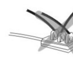
Enchufe el horno a un toma corriente instalado correctamente en la pared, no utilice un alargue compartido con otros aparatos eléctricos, esto podría derivar en un recalentamiento de la extensión eléctrica. Inserte el enchufe completamente en el toma corriente, si queda flojo esto podría derivar en un recalentamiento. No conecte nunca el horno a un adaptador múltiple.
